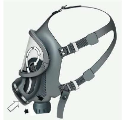
L'aria inalata, proveniente dall'erogatore, passa attraverso il connettore con filettatura M 45x3 (conforme alla EN 148-3), nella valvola di inalazione all'interno del facciale e poi, attraverso due valvole di controllo all'interno della mascherina oro-nasale.
