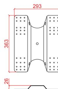
\* L'uso come dispositivo di Tipo C è ammesso soltanto se svolge la funzione di dispositivo intermedio lineare nelle linee vita Sicurlam. Esso non può essere utilizzato per costruire una curva, angolo o dispositivo di estremità e deve essere abbinato al kit B20.
